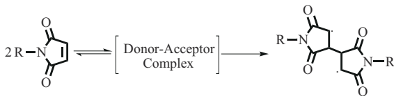
图5 马来酰亚胺自由基均聚反应的热引发机理 [21]
